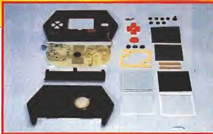
Sobre un acetato transparente, colocado sobre un papel plateado están impresos los decorados. ¡Parece imposible, pero es verdad!
